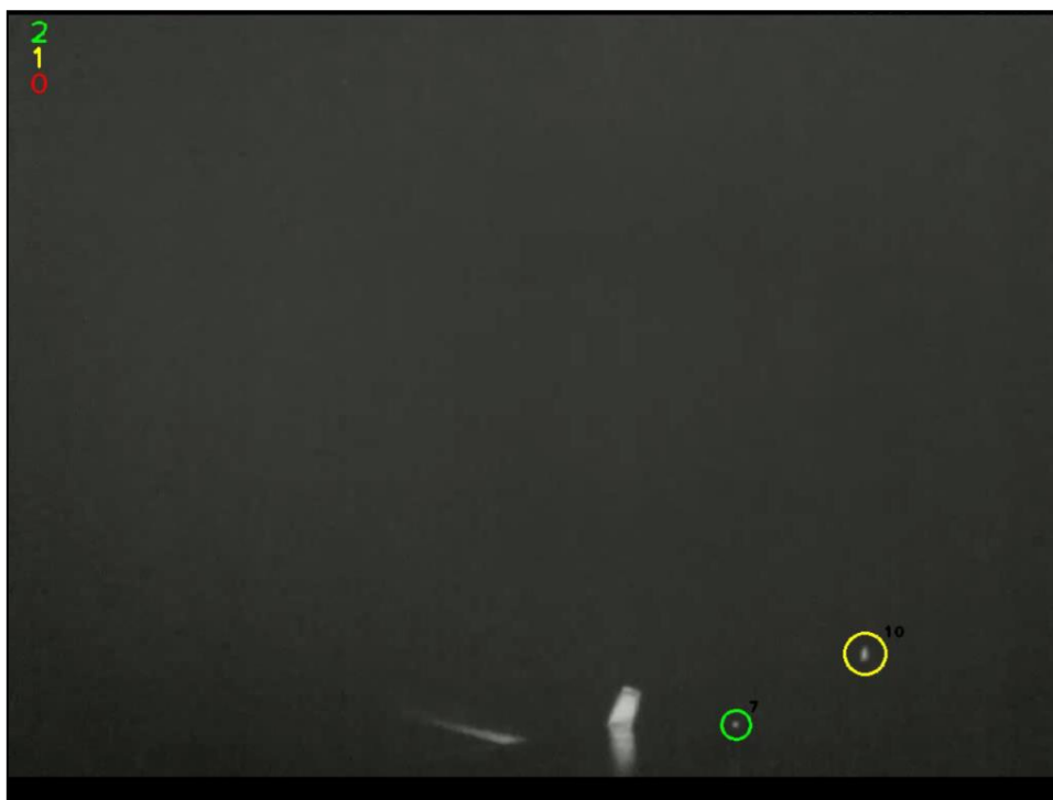
Figure 2 : Capture d’écran d’une vidéo analysée par SafeWind. Deux chiroptères étaient détectés à cet instant.
