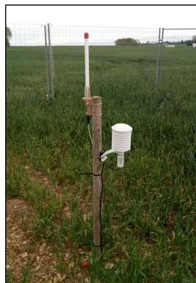
Figure 4 - Sondes de pression atmosphérique et température posées au sol à proximité du LIDAR (G. Marchais - Écosphère)
