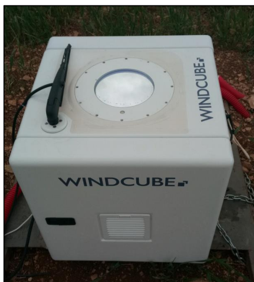
Figure 1 - Appareil LIDAR enregistrant les vitesses de vent jusqu'à 200 m d'altitude (G. Marchais - Écosphère)
