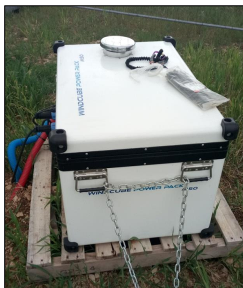
Figure 2 - Génératrice du LIDAR (G. Marchais - Écosphère)
