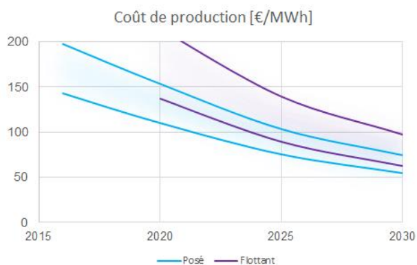
Figure 7 : Perspectives de réduction de l'éolien en mer en France consécutives à l'innovation technologique (ADEME, 2017)
