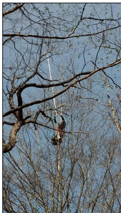
Photo 1 - Installation du micro en canopée à l’aide d’une perche télescopique de 6 m, le détecteur-enregistreur -SM3BAT- étant posé au pied de l’arbre dans un caisson sécurisé (G. Marchais - Écosphère)
