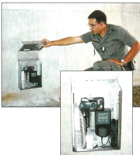
Photo n°1 : Piège-photo argentique utilisé dans les années 1990. (© VINCI Autoroutes, OGE).
