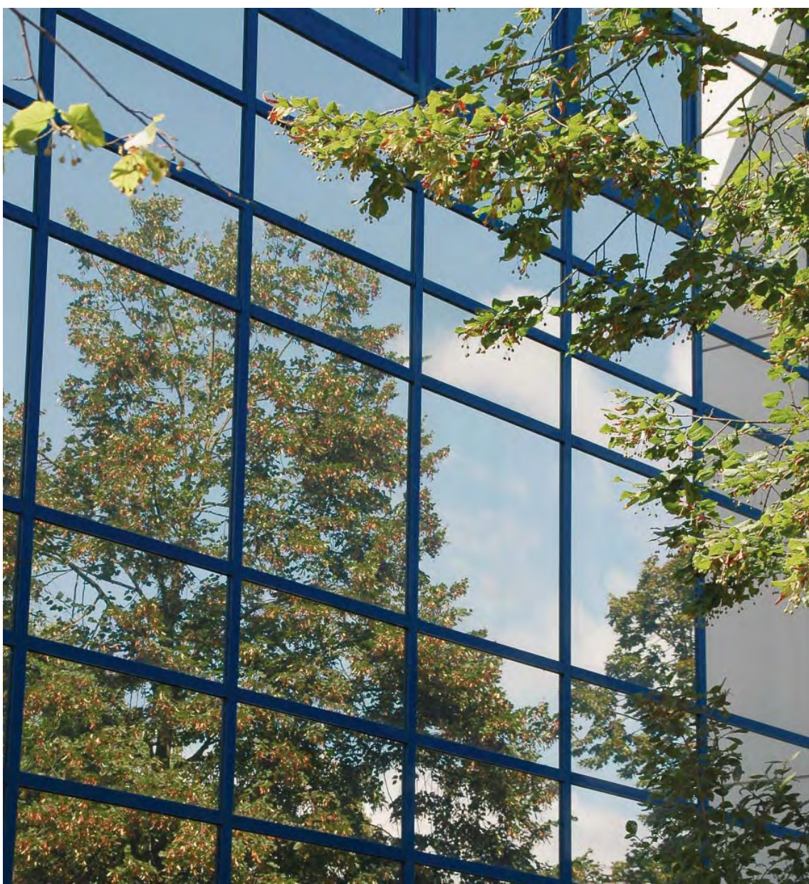
En raison du fort degré de réflexion, l'environnement est reproduit avec un grand réalisme sur les verres antisolaire. Le danger est particulièrement grand là où arbres et paysages naturels sont réfléchis.
