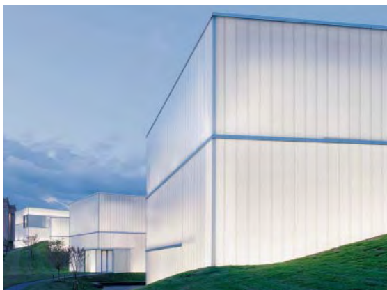
Les panneaux isolants diffuseurs de lumière (OKAPANE) placés à l'intérieur d'un verre profilé en double paroi permettent d'utiliser la lumière du jour et réduisent fortement les pertes de chaleur. Ils permettent une diffusion optimale et régulière de la lumière à l'intérieur du bâtiment.
