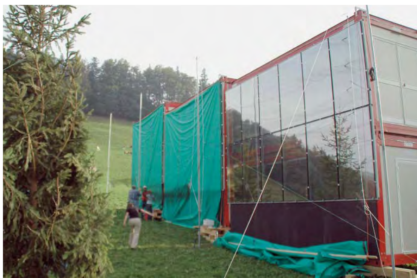
Installation pour les expériences de la Station ornithologique suisse sur un col du Jura. Cela devait permettre de tester l'efficacité des structures UV sur les oiseaux migrants. Une forte tempête a fait tomber l'installation peu de temps après sa construction. Fin de l'exercice....
